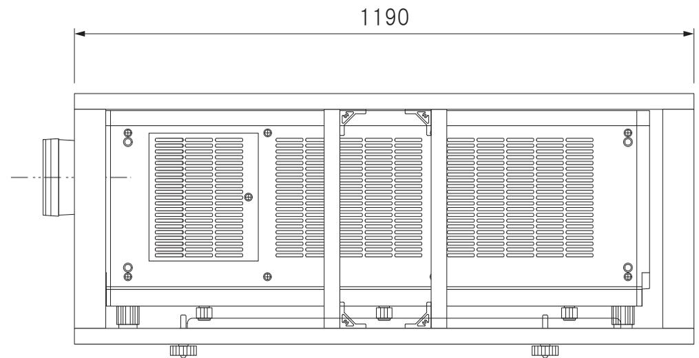
重量：約120.8kg(フレーム使用時)/約83kg(本体のみ)
